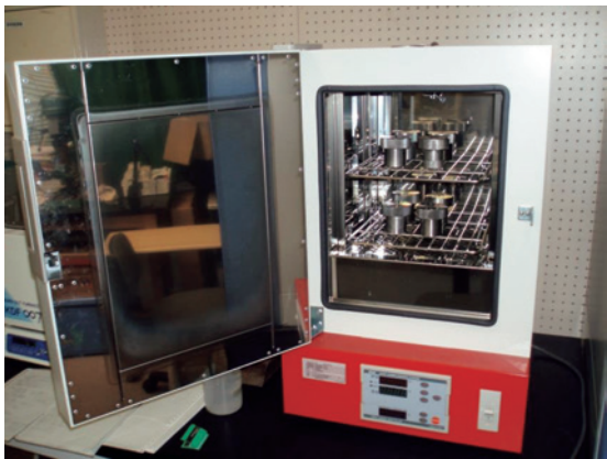
写真 14 ICP 発光分光分析のための前処理（王水 - フッ化水素酸分解）
