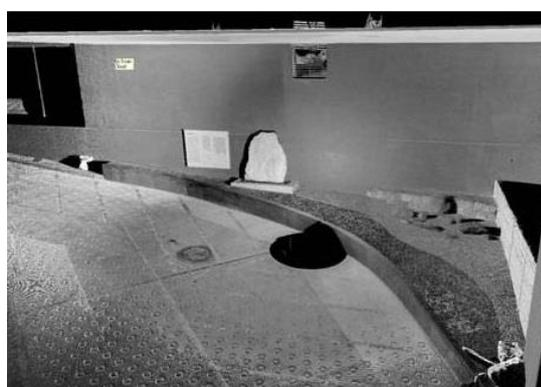
3Dレーザー scannerから得られたクラウド（点群）データ
